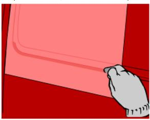
Una vez aplicadas las partes más profundas del corrugado, trabajar el interior del mismo. Comprobar que el material se mantiene a la temperatura requerida entre 40 y 50 °C y avanzar por toda la parte corrugada.
