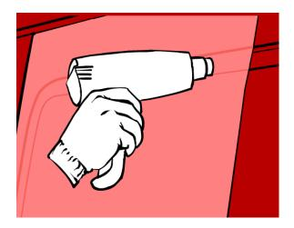
Empezar a estirar el material situado en la zona corrugada comenzando por la parte más profunda. Calentar el material de manera que se mantenga a una temperatura entre 40 y 50  $^{\circ}$ C.
