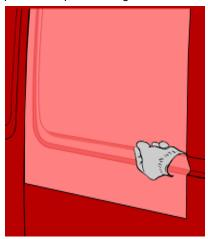
Una vez aplicados correctamente todos los bordes, es necesario aplicar el material del centro del corrugado. Al hacerlo, comprobar que no quede aire atrapado; dejar siempre un orificio para que pueda escapar el aire.
