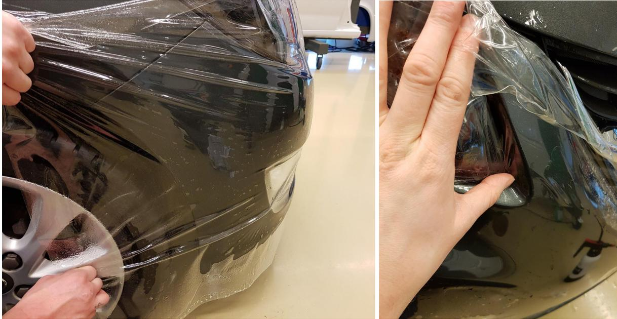
Avery Dennison Pure Defense PU presenta un buen nivel de conformabilidad, por eso es apto para cubrir formas convexas y compuestas del morro de los vehículos. No obstante, en las formas con ondulaciones profundas podría ser necesario realizar una incisión para evitar que quede agua o aire atrapados en los huecos profundos. Esta incisión no pone en riesgo la funcionalidad o durabilidad del Avery Dennison Pure Defense PU.
