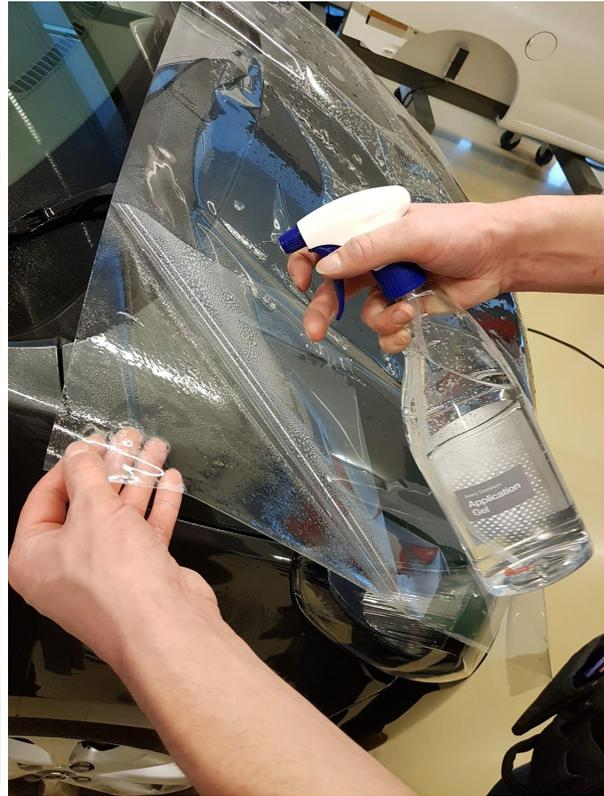
Retire el soporte y rocíe el lado adhesivo expuesto con la solución jabonosa. A continuación, coloque el material sobre la zona de aplicación seleccionada. Si fuera necesario, deslice el film hasta que quede bien colocado. Tire del film para colocarlo sobre la superficie de aplicación, dejándolo liso y sin arrugas.
