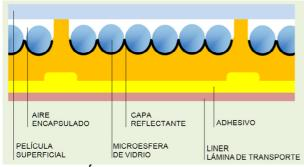
Las láminas CS512 y CV512 de Nikkalite ™ lámina retrorreflectante de microesferas encapsuladas han desarrolladas para proporcionar retrorreflexión y flexibilidad en su uso balizamiento y otro tipo de equipamiento de seguridad y control de tráfico.
