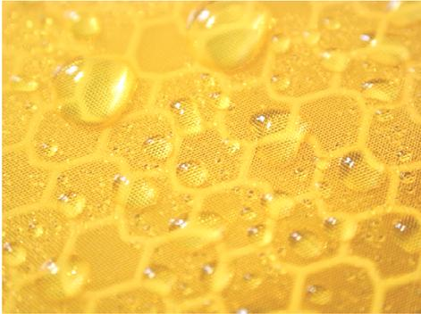
La nueva serie ULX R600 de Nikkalite™ láminas retrorreflectantes microprismáticas ha sido desarrollada para proporcionar aun mayor retrorreflexión y duración en su uso para señales de tráfico (Norma UNE: EN-12899-1) y para equipamiento de seguridad y control de tráfico.
