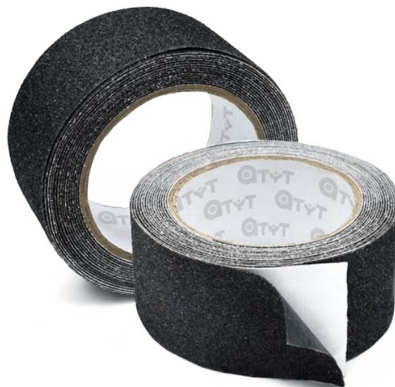
Cinta antideslizante, compuesta por un soporte de PVC con arena en su parte superior, con acabado rugoso y áspero y recubierto por un adhesivo acrílico solvente en su parte posterior, siendo este protegido por un liner siliconado de PE.
